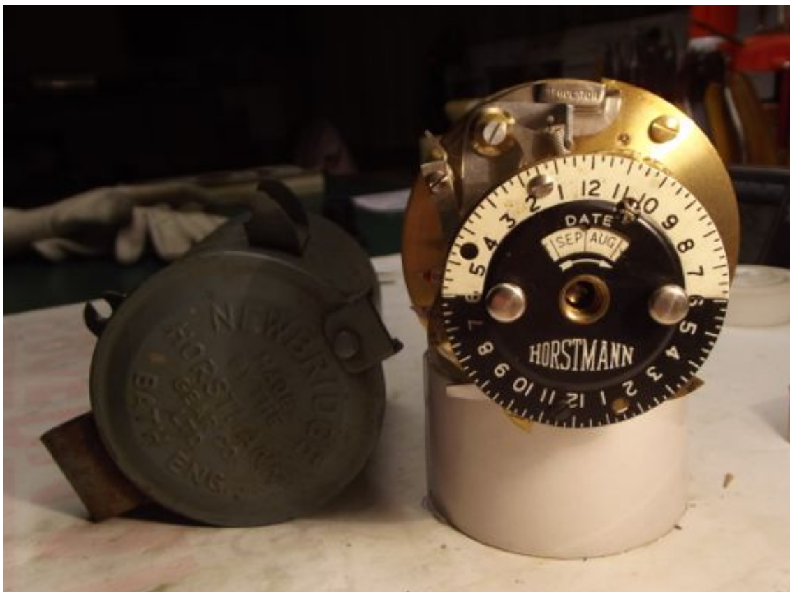
Hier läuft das überholte Werk auf dem Prüfstand. Die Schaltscheibe ist bereits auf der Zeigerachse aufgezogen.
