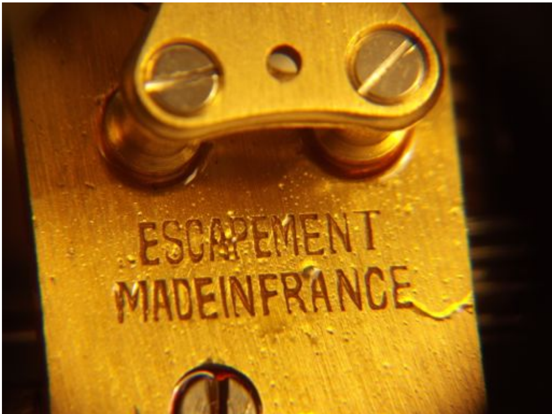
Die Messingplatte mit dem Vermerk des franz. Herstellers im Originalzustand vor der Überholung.
