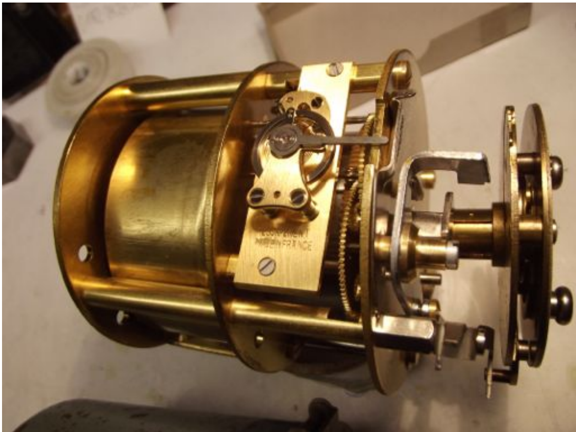
Die Oberseite des völlig überholten und komplettierten Uhrwerks.
