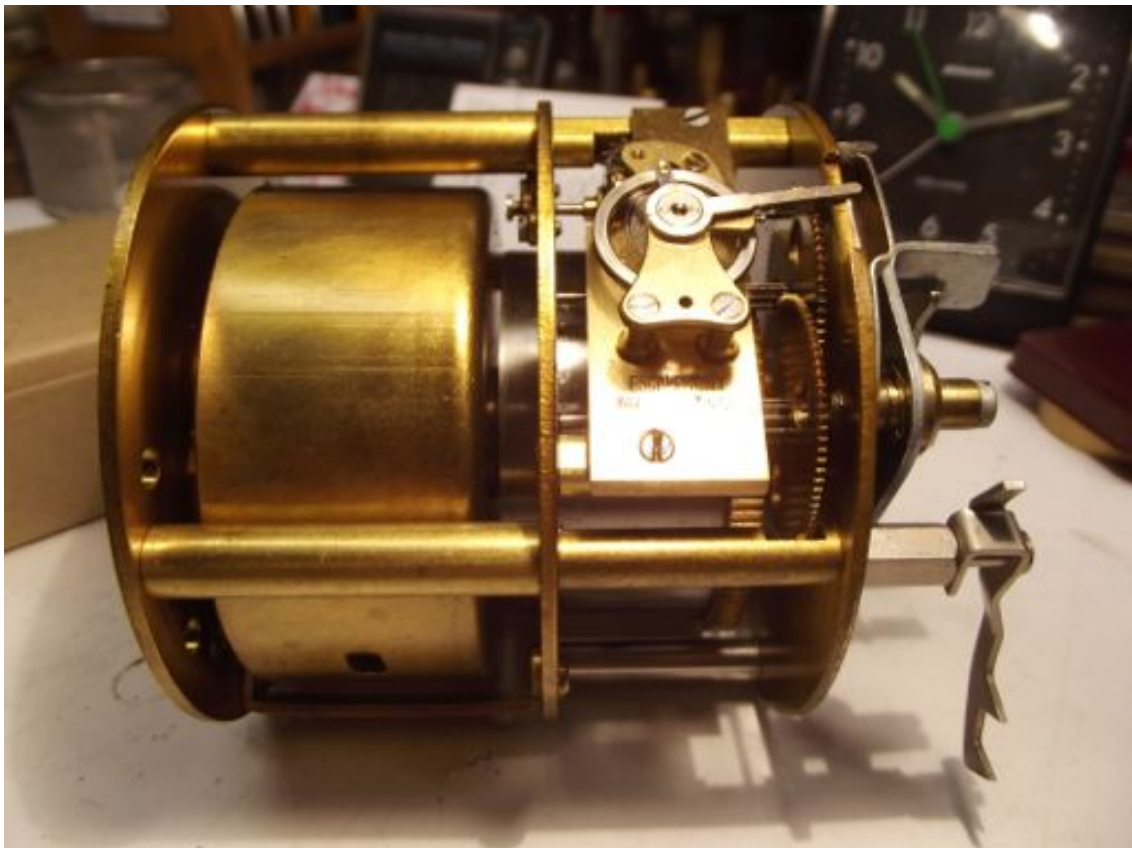
Die Oberseite des Uhrwerks mit der Unruh.
