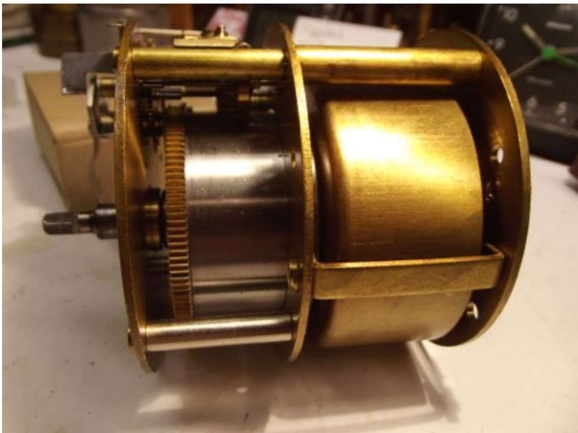
Die Unterseite des Werks mit ihren Federn.
