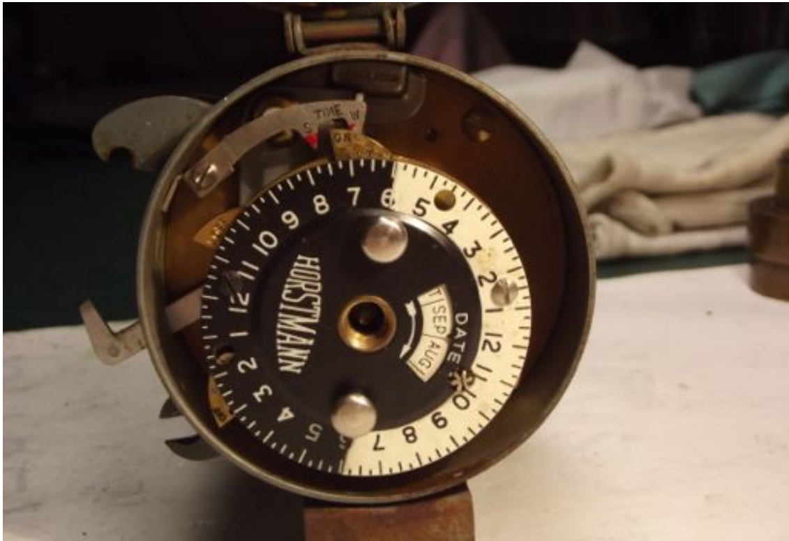
Die astronomische Schaltscheibe. Sie schaltet die Laterne in der Dämmerung im Sommer später ein und früher aus und im Winter früher ein und später aus. Dieses wichtige Uhrenteil ist m.E. ein Wunder der mechanischen Technik.
